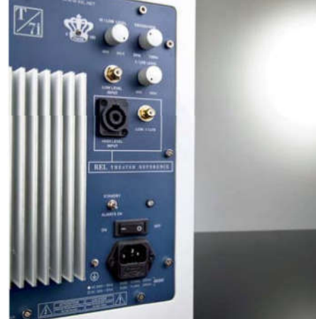
En gammal käpphäst hos REL är Speakon-kontakt för högnivåanslutning. Kabel för ändamålet medföljer och det går även att ansluta sig med vanlig RCA lågnivåsignal. Du kan ha både och anslutet samtidigt för film- respektive musiklyssning och har skilda volymrattar för ändamålen.
